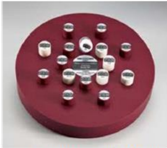
22. ábra: Gammex RMI 467 CT fantom és a CT fantomról készült felvétel
