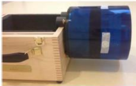
22. ábra: Gammex RMI 467 CT fantom és a CT fantomról készült felvétel
