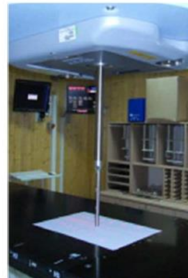
5. ábra: A mechanikai távolságmérő pozicionálása
